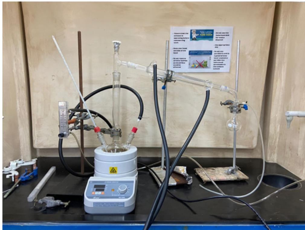
RAJAH 1. Susunan alat radas untuk tindak balas DO
